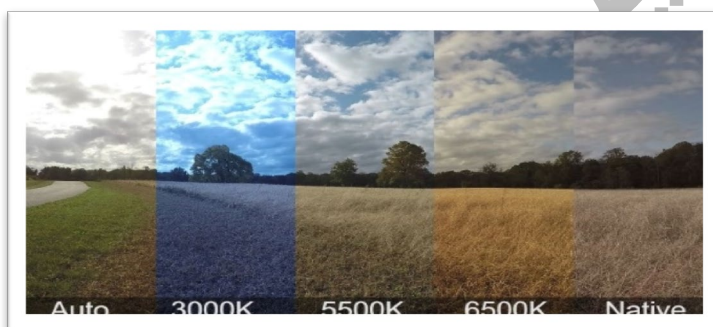
شکل ۳-۱۹- تنظیم خودکار سطح سفیدی در دوربین‌های رنگی
