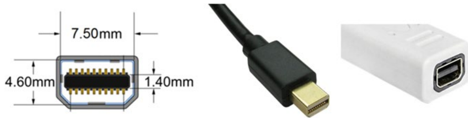
شکل ۸-۳۱- چند نمونه سوکت mini DP
