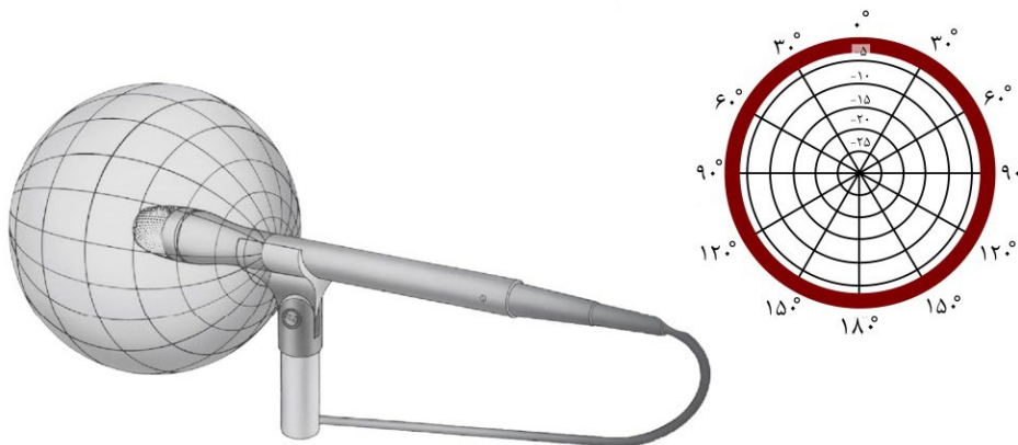
شکل ۷-۲۲ - منحنی الگوی قطبی و بالن الگوی قطبی میکروفن همه‌جهته
