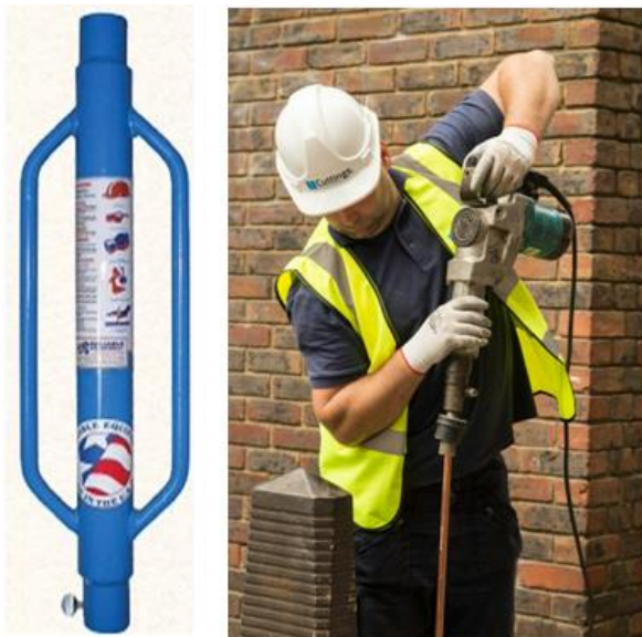
شکل (۲-۴): دو نمونه چکش مخصوص کوبیدن میله (سمت راست چکش برقی، سمت چپ چکش دستی)
