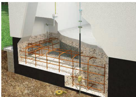
شکل (۲-۱۱): الکتروود مدفون در بتن
